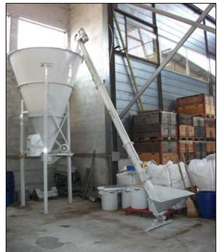
Mélangeur pour l'engrais VRS - PRO VERDE
